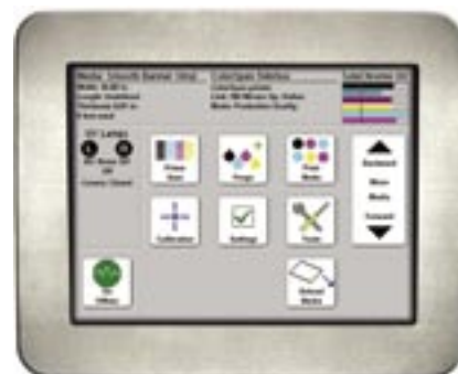
(Abbildung oben) Die Bedienung eines Druckers war noch nie so einfach. Auf dem farbigen 7-Zoll-Touchscreen werden Informationen zum Druckerstatus sowie benutzerfreundliche Symbole zur Bedienung des Druckers angezeigt.
